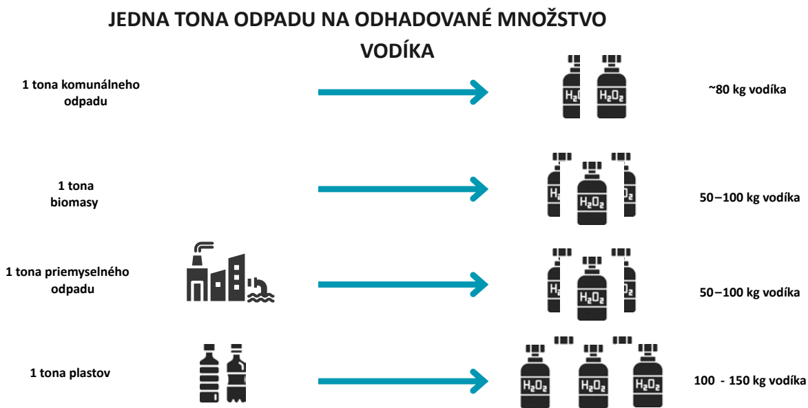
Obrázok 32: Ilustrácia výroby vodíka z rôznych druhov odpadu
