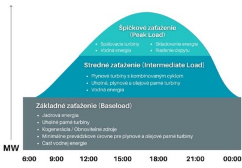
Obrázok 25: Priebeh elektrického zaťaženia sústavy a jeho pokrývania počas dňa
