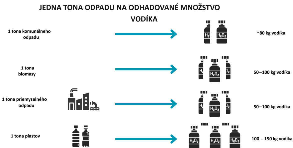
Obrázok 53: Ilustrácia výroby vodíka z rôznych druhov odpadu
